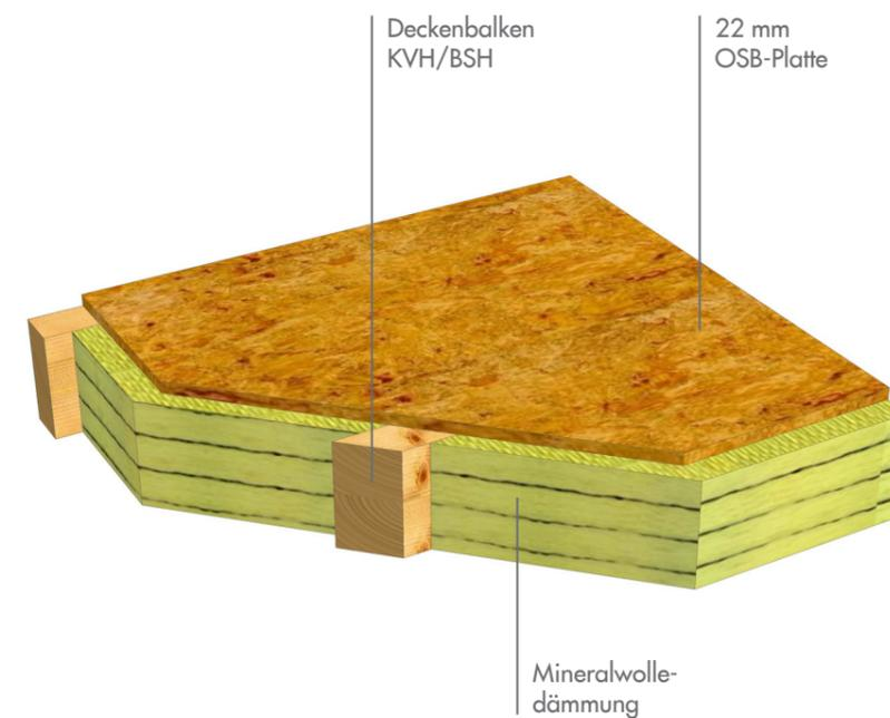
Diese Ausführung stellt ein klassisches Flächentragwerk dar. Die Deckenbalken mit Mineralwolle-dämmung erfüllen mit entsprechendem Zusatzaufbau alle Tritt- und Schallschutzanforderungen. Diese bewährte Standardvariante besticht mit einer effizienten Kosten-Nutzenlösung.
