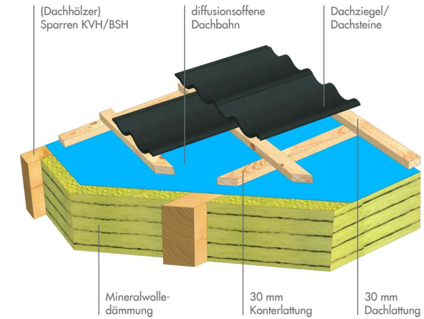
Der Aufbau des klassischen Dachsystems leistet beste Dämmqualität und erfüllt alle erforderlichen Normen des Wärmeschutzes. Diese Basisausführung überzeugt mit einem günstigen Kostenfaktor.
