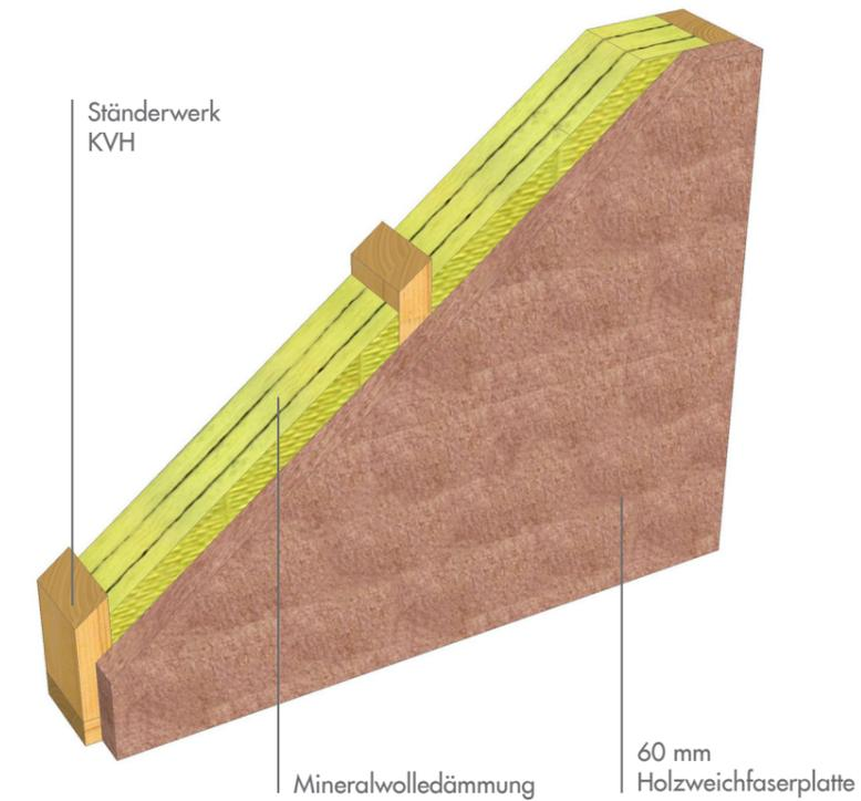
Das mehrschichtige Element verfügt über einen diffusionsoffenen Aufbau durch die Holzweichfaserplatte auf der Wandaußenseite. Beim Einbau kann somit auf eine ergänzende Dampfbremssolie verzichtet werden.
