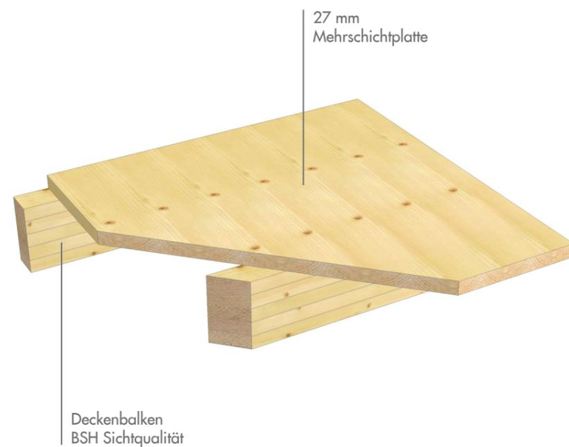
Die Variante der sichtbaren Decke ist ein Zusammenspiel der Mehrschichtplatte und des Deckenbalkens aus Brettschichtholz. Optisch attraktiv und hochwertig bietet diese Konstruktion dem Bauherrn Holzbalkendecken vom Feinsten.
