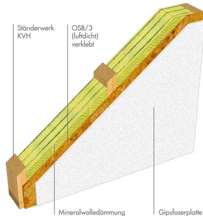
Bei der Herstellung dieser Einheit wird zum bewährten Holzkern noch eine OSB-Platte aufgebracht. Dieses Element bietet somit mehr Flexibilität, was die Anbringung von Gegenständen im Innenraum erleichtert. Bei einseitiger Beplankung bietet dieses Element ebenfalls einen größeren Spielraum bei der bauseitigen Eigenleistung.
