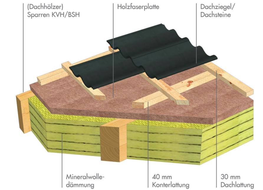
Dieses Dachmodul zeichnet sich durch seine erweiterte Funktionalität durch die integrierte Holzfaserplatte aus. Es bietet eine optimale Dämmung speziell bei starker Sonneneinstrahlung und hohen Außentemperaturen.
