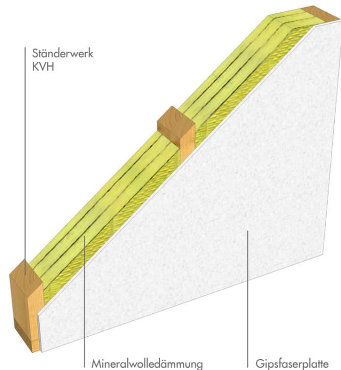
Schnelle und zügige Trennung von Räumen sowie sinnvoller Schallschutz wird durch dieses Bauteil auf kostengünstige Weise gewährleistet. Der Aufbau durch das Konstruktionsvollholz schafft die Möglichkeit, im Gebäudeinneren Zwischenwände ohne statisch tragende Funktionen individuell einzubringen. Die einseitige Beplankung gewährleistet eine schnelle Montage. Die Grundaufführung bietet Spielraum für eine hohe Eigenleistung.
