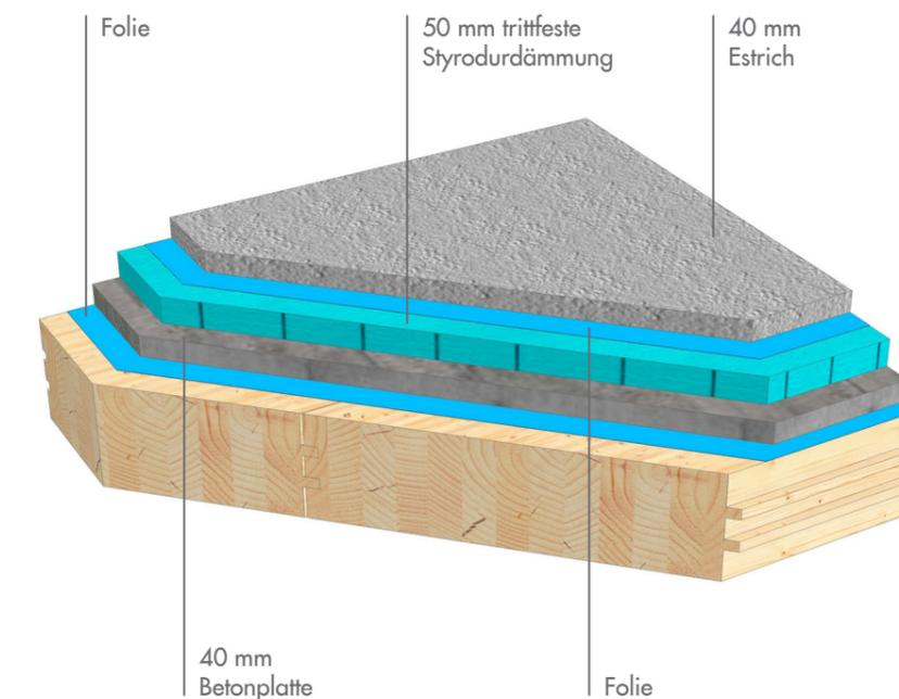
Das massive Brettschichtholz ermöglicht es, die Konstruktion unterseitig sowohl sichtbar als auch verdeckt zu verbauen. Die qualitativ hochwertige, mehrschichtige Ausführung des Deckenaufbaus erfüllt selbst sehr hohe Anforderungen an den Schallschutz.
