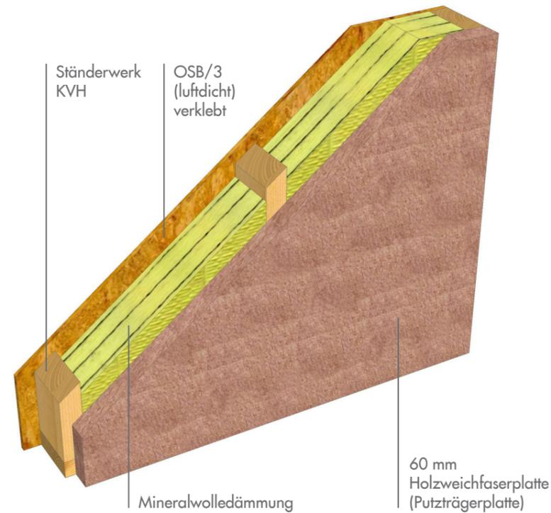
Variante mit Putzträger/OSB/Gipskarton
